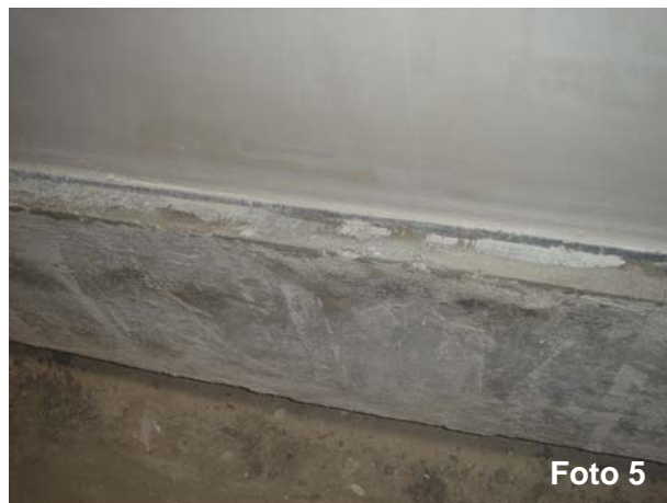
Foto 5: Detalle de unión inferior fábrica-marco portamuestras
