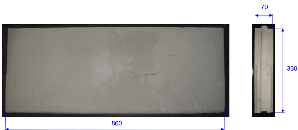
Figura 2: Dimensiones de bloque "Lateroyeso 7 LD" (cotas en mm)
